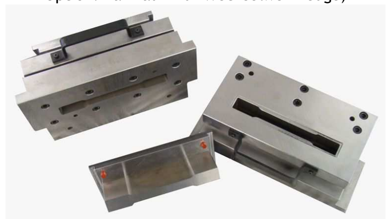
Demontiertes Stanzwerkzeug für Zugproben auf seitlichem Rollentisch Option: Parkraum für Wechselwerkzeuge)
