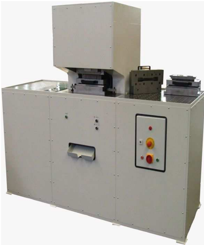
Beispielfoto eine C-Formstanze Typ ZS 1200 mit seitlichen Parktischen als Parkraum für die Stanzwerkzeuge
